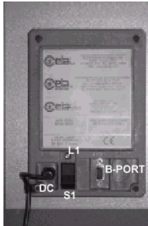
Рис. 2-5д Вид нижней панели разъемов
