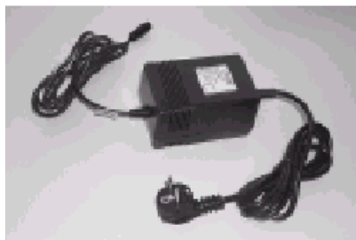
Рис. 1-5 Преобразователь напряжения (подключается к электронному блоку управления) Входное напряжение: 230 или 115 \pm 15\% В AC Выходное напряжение/ток: 30 В DC/1 А Габариты: 121x80x71 (LxWxH) Длина кабеля со стороны вилки: 2 м Длина кабеля со стороны блока управления: 2 м Вес: 1,5 кг
