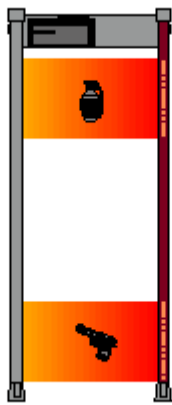
Рис. 3-6б – индикация тревоги для двух металлических объектов
